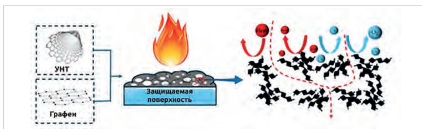
Рис. 4. Синергетический эффект графена и углеродных нанотрубок в огнестойком покрытии
